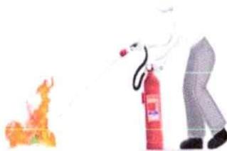
**3** Sujeta la manguera, oprime la palanca y dirige la descarga a la base de la llama.
