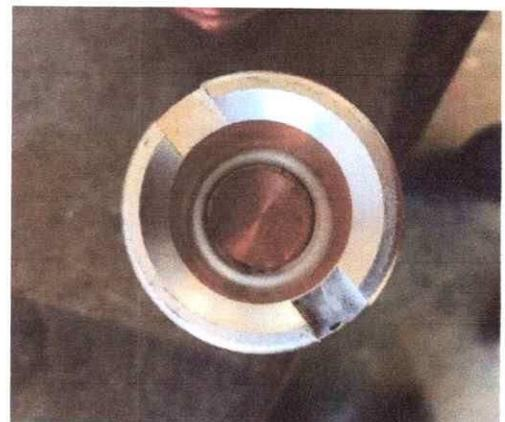
Figura 5: Daño a contacto hembra y macho por quemadura
